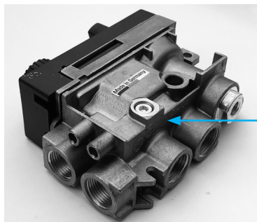
Rys. 22. Sposób regulacji minimalnej wysokości płomienia palnika głównego
