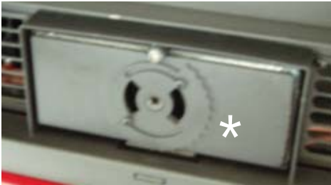
Ventil zur Regulierung der Verbrennungsluft, einsetzbar bei geschlossener Tür über Kalthandgriff
